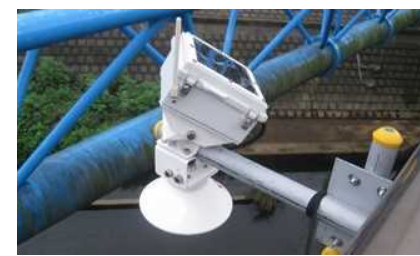
洪水に特化した低コストな水位計の設置例
