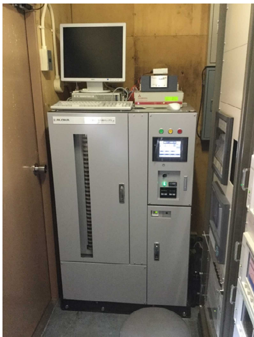
図1 ゲルマニウム半導体検出器ダストヨウ素モニタ測定部
