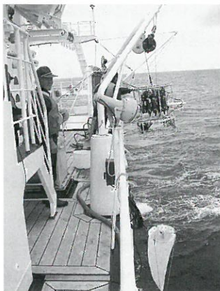
写真1. 観測機器 手前のネットは動物プランクトンネット、奥の機械(CTD)は水温・塩分・圧力等のセンサーです。ネットは水深150mまで、CTDは深いところでは1000mまで降ろします。
