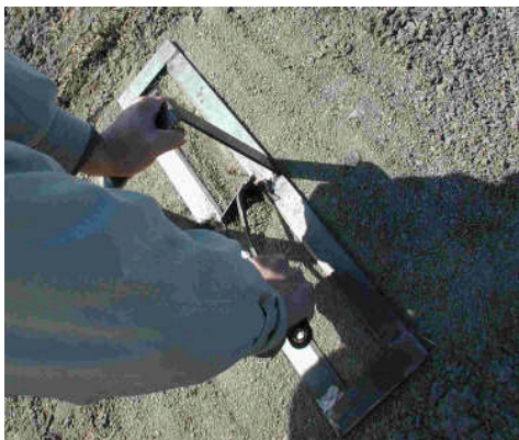
第2図 法面播種用削溝器
