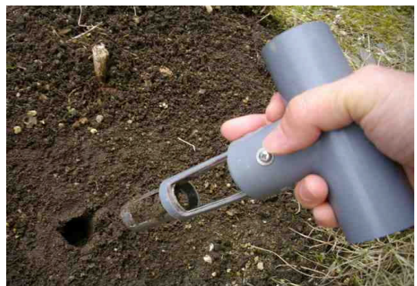
第3図 セル成型苗移植用削孔器
